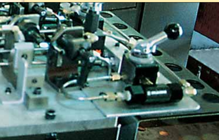
■ V-17 Rückschlagventil auf einer Spannvorrichtung.
