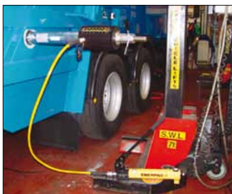
◀ Un vérin RACH-306 alimenté par une pompe à main P-392 est utilisé pour extraire une goupille corrodée dans une benne à déchets.
